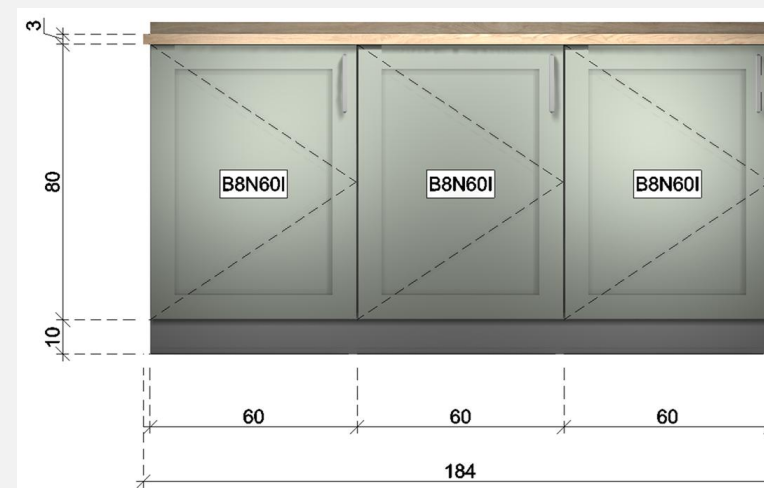
Alzado acotado con línea discontinua, código de mueble enmarcado con relleno y representación de apertura 2D configurable
